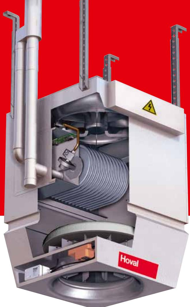
Kod TopVent® plinsko loženih jedinica, toplina se stvara pomoću decentraliziranog, plinskog izmjenjivača topline. Uz modulirajući predmiješajući plamenik, štetne razine emisija zadržavaju se na minimumu, čime se jamči isplativost i ekološka učinkovitost. Sustavi se isporučuju spremni za uključenje s ovjesnim setom i dodatkom za ispumpavanje.
