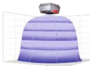
**Hlađenje:** Ubrizgani zrak je hladniji od zraka u prostoru, te se stoga lagano spušta prema dnu prostorije. Za izbjegavanje propuha, potrebno je horizontalno istrujavanje.
