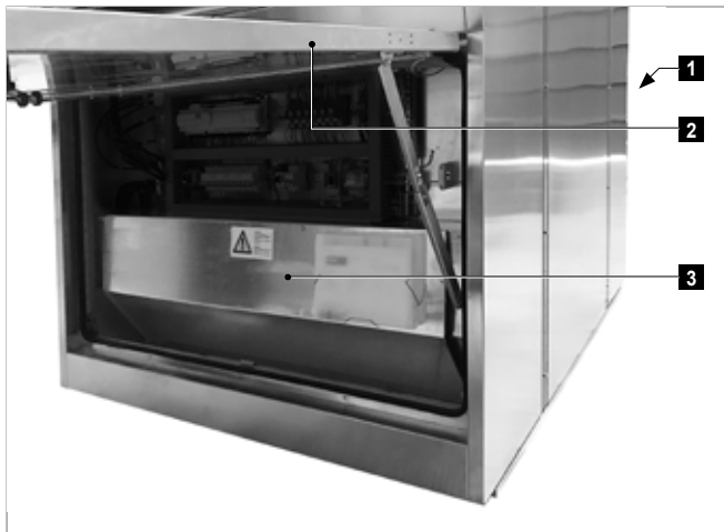
Slika 13: Za vrijeme isporuke zaštitna ploča ventilatora privremeno je pričvršćena s 4 vijka
