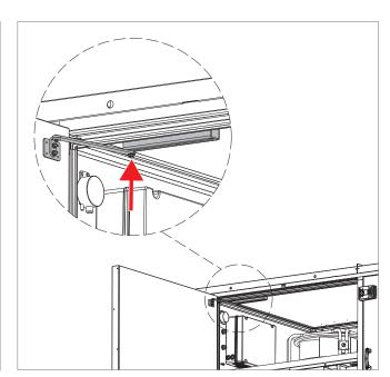
Fig. 46: Unlocking the door holder
